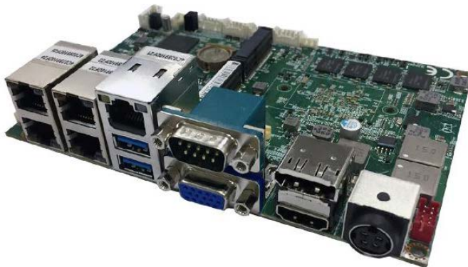
图 1. LEX Computech 3I390NX 系列主板提供四个 PoE 端口。 (来源: LEX Computech )
